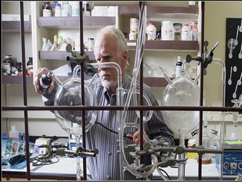
Fotoğraf-1: Miller-Urey'in deney düzeneği ve öğrencileri Jeffrey Bada (Bakırcı, 2011b)
